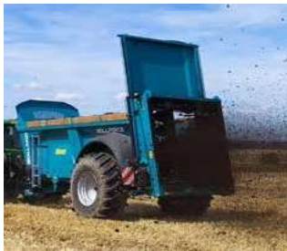
Zsalu a kijuttatott mennység beállításához*
