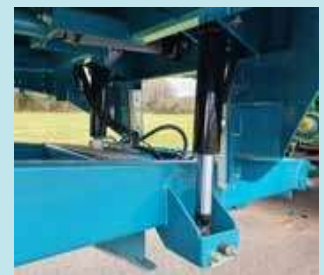
Hidraulikus csillapítású vonórúd a maximális kényelemért*
